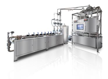
El banco B28 VTB está diseñado para la calibración y el procedimiento de prueba del medidor de calor / medidor de agua. Con el diseño exclusivo del sistema de flujo y el sistema de ponderación de BOVE, admite cualquier rango de tamaño desde DN15 hasta DN600.
